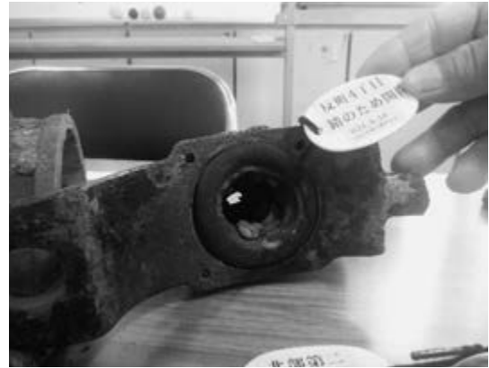
錆びのため開閉できなくなったボール弁
